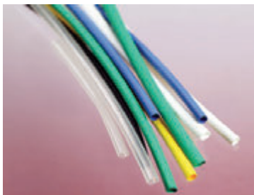
Рис. 3.21. Наденьте отрезок термоусадочной трубки на место соединения проводов без изоляции и, чтобы сделать прочную изоляцию вокруг этого соединения, прогрейте его с помощью промышленного фена
