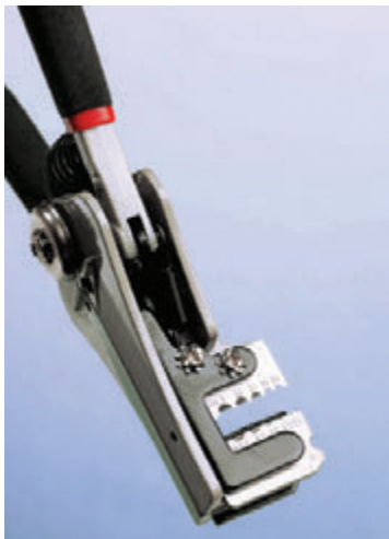
Рис. 2.5. Такие автоматические устройства для снятия изоляции дают возможность выполнять эту операцию, используя только одну руку, но непригодны для снятия изоляции с проводов малой толщины (см. подразд. «Инструменты» разд. Эксперимент 6. Очень простое переключение» этой главы)
