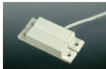
Рис. 3.66. В этом простом датчике охранной сигнализации в нижнем модуле находится магнит, который замыкает и размыкает герконовый переключатель, расположенный в верхнем модуле датчика
