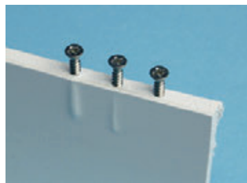
Рис. 5.89. Три самореза #4 завинчены в край АБС-пластика с использованием предварительно выполненных отверстий диаметром 1/16" (1,6 мм), 5/64" (2 мм) и 3/32" (2,4 мм) соответственно. Поскольку два первых отверстия (слева) имели слишком маленький диаметр по сравнению с диаметром самореза, то это привело к вздутию пластика (вокруг самореза, но при этом он все же не сломался)
