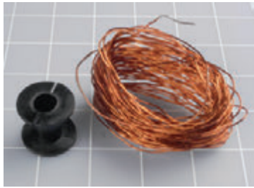
Рис. 5.47. Катушка для разделительного фильтра звуковых частот состоит из пластиковой катушки и некоторого количества обмоточного провода, и ничего больше
