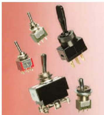
Рис. 2.28. Все эти переключатели являются тумблерами. Как правило, чем большие размеры имеет переключатель, тем больший ток он может коммутировать
