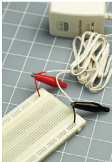
Рис. 2.71. Если ваша макетная плата не имеет винтовых клемм, то надо к ней присоединить два коротких одножильных провода с оголенными концами, а уже к ним с помощью «крокодилов» подключать многожильные провода сетевого адаптера
