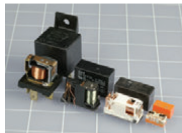
Рис. 2.53. Четыре различных реле на рабочее напряжение 12 В для наглядности показаны в корпусах и без них. Автомобильное реле (крайнее левое) самое простое из них и его принцип работы легко понять, поскольку оно спроектировано без особого стремления сделать все максимально компактно. Миниатюрные реле небольшого размера сконструированы с высокой степенью изобретательности, они имеют более сложную конструкцию, которую не так просто понять. Обычно, но не всегда, реле небольшого размера спроектированы соответственно для меньших значений тока, чем большие
