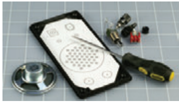
Рис. 3.86. Распечатанная схема компоновки переключателей, светодиодов и других компонентов, приложенная к обратной стороне передней панели корпуса. Следует использовать шило, чтобы сквозь бумагу наметить центры всех отверстий, которые надо будет просверлить
