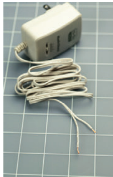
Рис. 2.47. Затем, чтобы уменьшить риск соприкосновения оголенных частей проводов, нужно обрезать и зачистить провода, сделав один из них короче другого. Чтобы впредь было легче ориентироваться в проводах, один из них, на котором имеется положительное выходное напряжение, пометьте красным маркером
