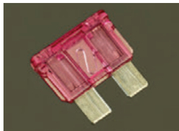
Рис. 1.32. Целый автомобильный предохранитель номиналом 3 А до проведения опыта
