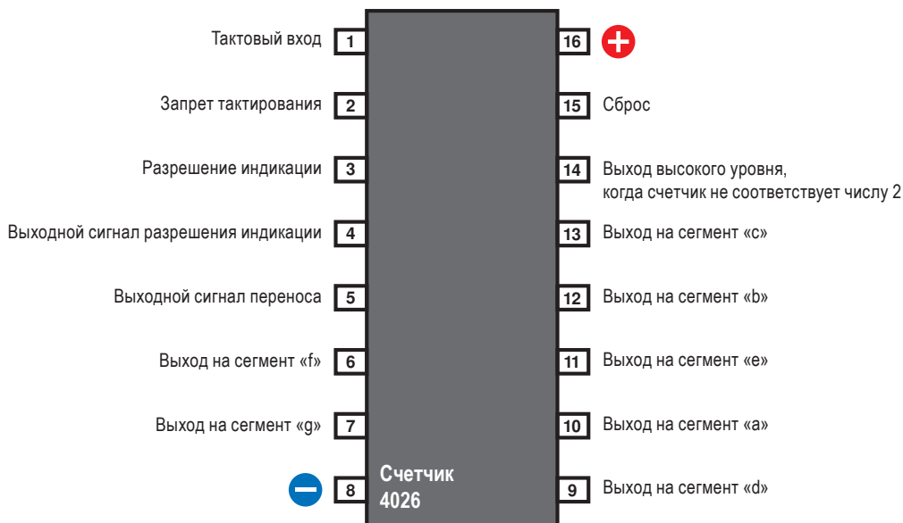
Рис. 4.36. Десятичный счетчик 4026 представляет микросхему, выполненную по технологии КМОП (CMOS), которая получает синхронизирующие тактовые сигналы, поступающие на вывод 1, считает их от 0 до 9, дешифруя полученный код в выходные сигналы, соответствующие интерфейсу трехзначного цифрового семисегментного индикатора
