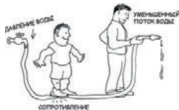
Рис. 1.30. Чем больше результирующее значение сопротивления, тем меньше поток — но если вы увеличиваете давление, то вы можете преодолеть сопротивление и создать больший по величине поток
