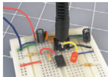
Рис. 5.132. Версия макетной платы тестируемой схемы со вставленной вилкой USB-кабеля в гнездо на плате для загрузки программного обеспечения. Теперь микроконтроллер PICAXE готов получать и загружать программу, а также начать немедленно выполнять ее инструкции
