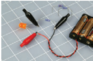
Рис. 1.40. Вид собранной схемы при выполнении эксперимента 3 , на которой применяются резисторы с сопротивлением 470 Ом, 1 и 2 кОм. Для выполнения надежного контакта подсоедините зажимы типа «крокодил», как это показано на рисунке. Кроме того, в одном и том же месте цепи попробуйте по очереди поменять все используемые в эксперименте резисторы, наблюдая за тем, как при этом меняется свечение светодиода
