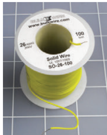
Рис. 5.18. Обычная катушка монтажного одножильного провода длиной 100 футов (30 м) в состоянии продемонстрировать свои индуктивные свойства
