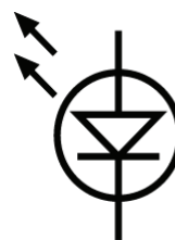
Рис. 2.43. Иногда светодиоды изображают с кружком вокруг символа диода; иногда нет. В этой книге я везде добавляю кружок. Стрелки означают излучение света
