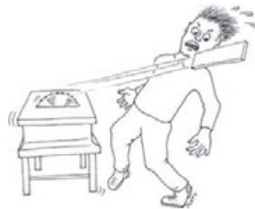
Рис. 5.76. Опасность вылета распиливаемого материала. Пластик легко прилипает к диску настольной пилы, что приводит к неожиданному его вылету в вашу сторону. Для разрезания пластика все же лучше воспользоваться другим инструментом
