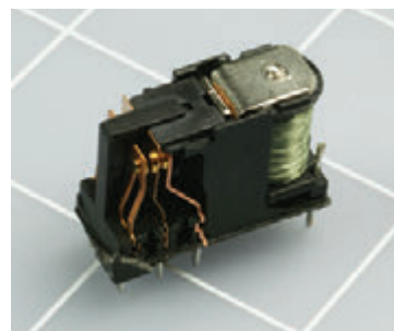
Рис. 2.51. Если вы будете очень осторожны, то после того как вы вскрыете реле, оно может остаться в рабочем состоянии
