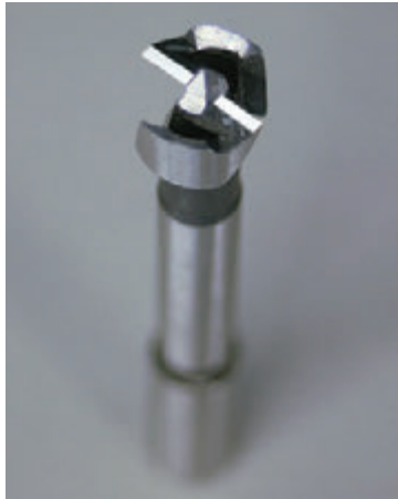
Рис. 5.83. С помощью специального сверла Форстнера (Forstner) можно выполнять чистые и аккуратные отверстия; обычное сверло большого диаметра будет «зажевывать» АБС-пластик, что безусловно будет приводить к браку
