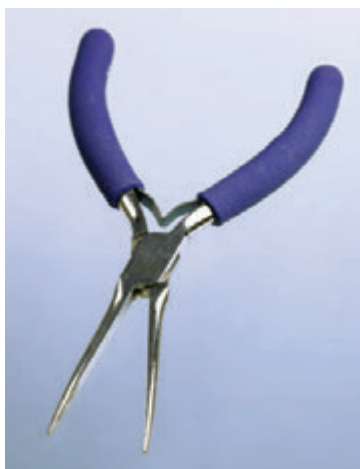
Рис. 1.2. Длинноносые тонкогубцы: они очень полезны для работы в местах с ограниченным доступом
