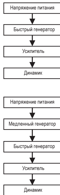
Рис. 2.106. Верхняя часть рисунка: блок-схема генератора звуковых колебаний, работающего на относительно высокой частоте («быстрый» генератор). Нижняя часть рисунка: блок-схема генератора, в котором добавлен относительно низкочастотный («медленный») генератор для управления другим («быстрым») генератором, работающим на более высокой частоте
