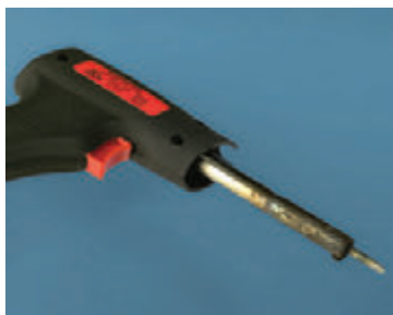
Рис. 3.2. Этот паяльник достаточно большой мощности создает дополнительный разогрев, который необходим для пайки толстых проводов и компонентов большого размера. При постоянном использовании паяльника он со временем теряет свой первоначальный вид, что никоим образом не сказывается на его эксплуатационных характеристиках, если поддерживать его жало в чистом состоянии
