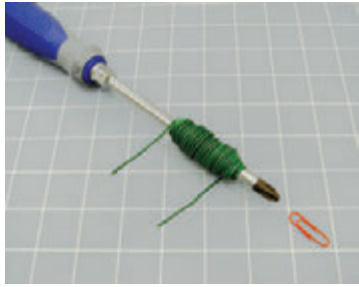
Рис. 5.11. Любой, кто почему-то забыл эту главную демонстрацию электромагнетизма для детей, должен попытаться повторить ее просто для удовольствия, чтобы доказать, что одна батарейка размером AA в состоянии двигать канцелярскую скрепку
