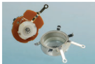
Рис. 1.43. Чтобы открыть потенциометр, сначала надо отогнуть четыре небольшие металлические лапки, расположенные по краю металлического корпуса (на нижнем рисунке видно две лапки, отогнутые наружу — одна влево и одна вправо). Внутри находится однослойная спираль из проволоки, намотанной или круглой плоской пластмассовой полоски, и пара подпружиненных контактов, которые проводят ток к нужной точке или отводят от другой нужной точки катушки при вращении оси потенциометра (показаны на верхнем рисунке). В зависимости от того, какого типа потенциометр у вас есть, относительно недорогой или более дорогой, внутри их вы можете обнаружить дорожку проводящей графитовой пленки или проволочную спираль. В любом случае используемый принцип действия будет один и тот же
