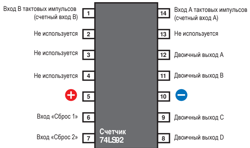
Рис. 4.99. Микросхема имеет несколько необычное назначение четырех выводов, которые не имеют каких-либо подключений внутри микросхемы и поэтому могут быть оставлены нигде не подключенными
