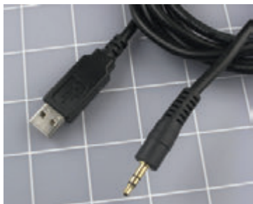
Рис. 5.124. Интерфейсный USB-кабель для загрузки программного кода в микроконтроллеры PICAXE требует для подключения аудиоразъем под вилку 3,5-мм. Кабель должен вставляться в любое аудиоустройство. Он обеспечивает последовательное подключение к компьютеру, предоставляя возможность загрузить в микроконтроллер программный код
