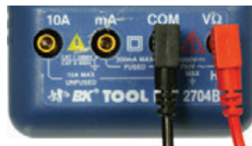
Рис. 1.18. Чтобы измерить сопротивление и напряжение, нужно вставить черный измерительный провод в гнездо «COM», а красный в гнездо «V». Почти все мультиметры имеют отдельное гнездо, в которое вставляют красный измерительный провод только при необходимости выполнить измерение силы тока большой величины в амперах, но мы познакомимся с этой процедурой позднее
