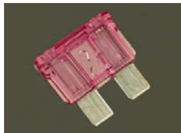
Рис. 1.33. Тот же самый предохранитель после того, как он был расплавлен электрическим током
