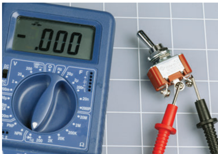
Рис. 2.30. Когда переключатель замкнет контакты, то между соответствующими его выводами, к которым подсоединены измерительные щупы мультиметра, установленного в режим прозвона, прибор будет показывать нулевое сопротивление, и при этом еще раздаваться звуковой сигнал
