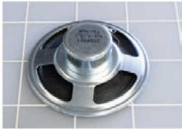
Рис. 5.24. Динамик диаметром 2" (50 мм) может быть последовательно разобран с помощью универсального ножа или ножа X-Акто
