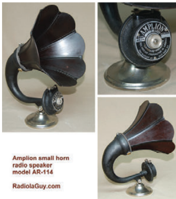
Рис. 5.28. Этот замечательный граммофон Amplion AR-114x показывает какие усилия предпринимали первые конструкторы, чтобы увеличить эффективность воспроизведения звука, когда мощность аудиоусилителей была очень ограниченной. Фотографии от «Sonny, the RadiolaGuy». Изображения первых динамиков показаны на сайте www.radiolaguy.com . Некоторые из них можно приобрести
