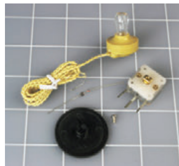
Рис. 5.59. К всему этому просто добавьте провод и катушку и это будет все, что нужно для приема сигналов АМ-радио. Черный диск становится регулятором настройки после того, как он будет прикреплен к переменному конденсатору (справа). Это на самом деле избыточная добавка. Германиевый диод (в центре) осуществляет выпрямление радиосигнала. Наушник с большим значением сопротивления (в верхней части рисунка, желтого цвета) создает хорошо различимый на слух звук
