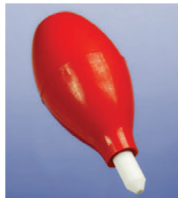
Рис. 3.10. Чтобы очистить паяное соединение, вы можете нагреть припой до тех пор, пока он не станет жидким, а затем с помощью резиновой груши (этого простейшего устройства) отсосать его
