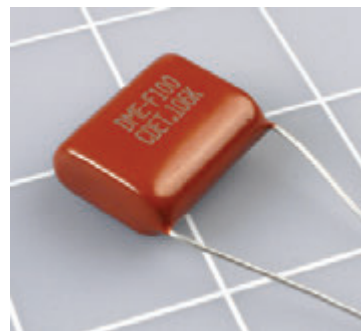
Рис. 5.44. Некоторые электролитические конденсаторы не имеют полярности, например этот конденсатор на основе полиэфирной пленки. Однако они стоят существенно дороже и конденсаторы, у которых емкость более 10 мкФ, найти достаточно сложно
