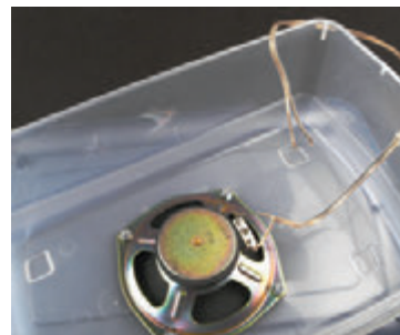
Рис. 5.39. Если вы хотите услышать низкие частоты из вашего динамика, то для этого необходима какая-нибудь резонансная оболочка. Дешевой пластиковой обувной коробки для демонстрации будет вполне достаточно.
