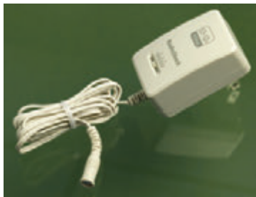
Рис. 2.1. Этот сетевой адаптер на выходе выдает напряжение от 2 до 12 В и является идеальным устройством для реализации электронных проектов
