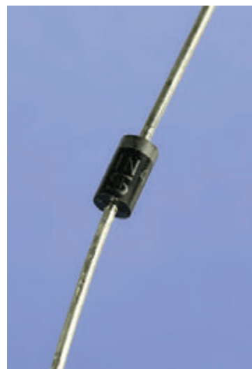
Рис. 3.30. Этот диод 1N4001 длиной примерно 0,25" (6,35 мм) в состоянии выдерживать напряжение до 50 В
