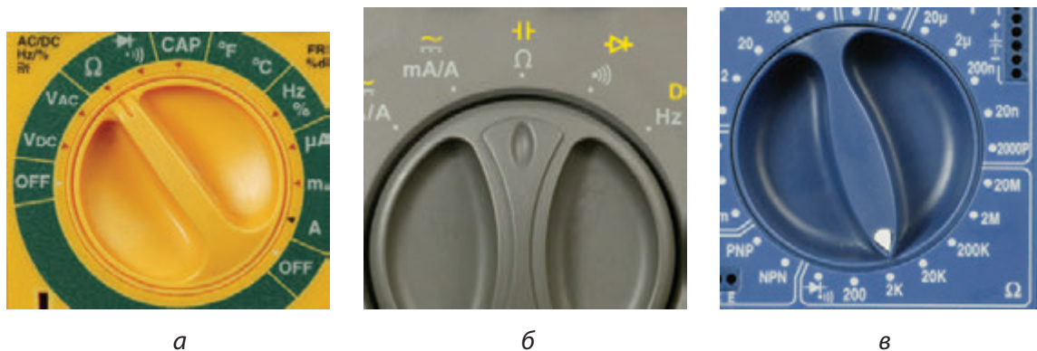
Рис. 1.21. Чтобы измерить сопротивление в омах, нужно повернуть переключатель режимов в положение для измерения сопротивления. На мультиметре этот режим обозначен греческой буквой омега — \Omega . При использовании прибора с функцией автоматического выбора диапазона измерения (а и б) вы можете несколько раз нажать кнопку Range (диапазон) (см. рис. 1.6–1.7) для отображения различных диапазонов измерения сопротивления или просто прикоснуться концами измерительного щупа к резистору и дождаться пока прибор не выберет диапазон автоматически. В мультиметре с ручным выбором диапазона измерения (в) требуется установить переключатель диапазонов на соответствующее значение. Чтобы измерить сопротивление кожи вы должны установить диапазон «100K» или больше. Если же вам не удалось установить нужный диапазон, то следует попробовать другой
