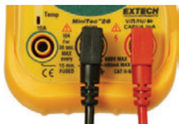
Рис. 1.18. Чтобы измерить сопротивление и напряжение, нужно вставить черный измерительный провод в гнездо «COM», а красный в гнездо «V». Почти все мультиметры имеют отдельное гнездо, в которое вставляют красный измерительный провод только при необходимости выполнить измерение силы тока большой величины в амперах, но мы познакомимся с этой процедурой позднее
