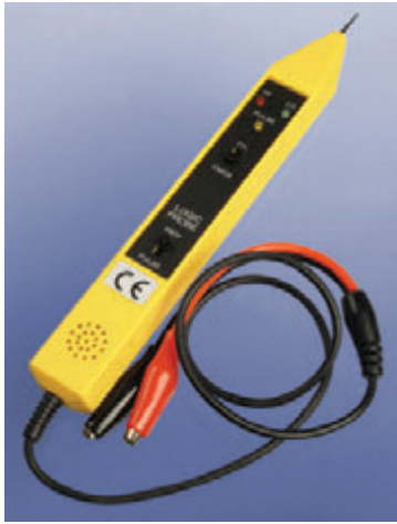
Рис. 4.1. Логический пробник позволяет определить уровень напряжения на каждом выводе микросхемы, а также показывает наличие импульсов, которые могут быть слишком короткими, чтобы их можно было заметить невооруженным глазом
