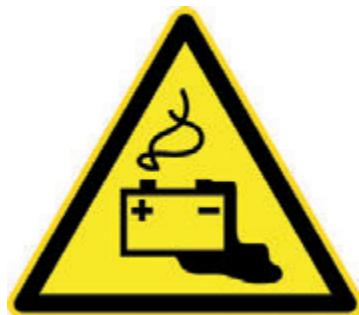
Рис. 1.27. Низкое внутреннее сопротивление литиевой батарейки (которая часто используется в ноутбуках) при замыкании приводит к достижению максимального значения тока с непредсказуемыми результатами. Никогда не теряйте бдительности вблизи литиевых батареек!
