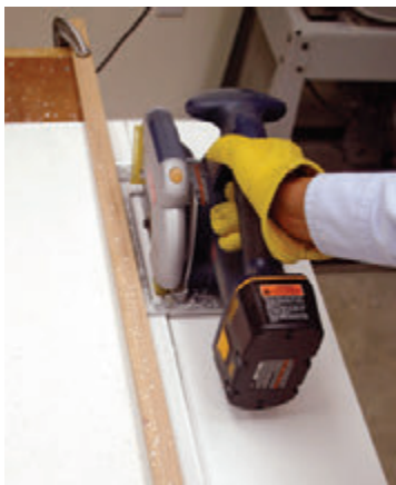
Рис. 5.78. Ручная циркулярная пила, которая распиливает вдоль закрепленной направляющей линейки, намного безопаснее настольной пилы при разрезании пластика, но при этом дает возможность добиться сравнимого с ней по качеству результата
