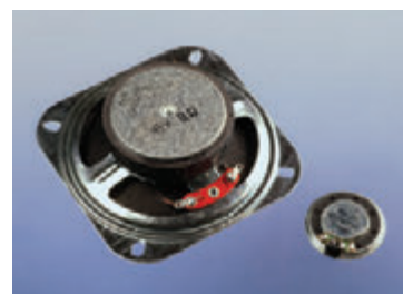
Рис. 2.107. Биполярный транзистор 2N2222 в состоянии подать сигнал достаточной мощности на динамик диаметром 3", который может выдать звуковой сигнал более высокого качества
