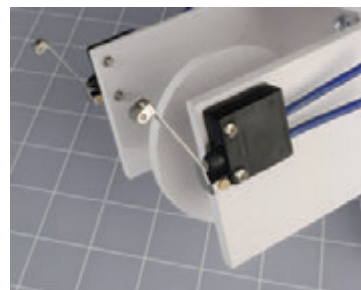
Рис. 5.97. Два микропереключателя с металлическими рычажками расположены с каждой стороны тележки, где они будут хорошо «чувствовать» каждое встречающееся препятствие
