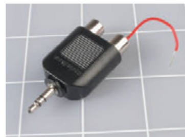
Рис. 5.42. Чтобы подключить выходной сигнал с гнезда наушников музыкального плеера, вы можете использовать данный адаптер и вставить зачищенный конец провода в одно из его гнезд. Затем следует использовать «крокодилы», чтобы подключить аудиосигнал к вашей макетной плате. Не забудьте применить дополнительный навесной провод для соединения общего контакта адаптера с минусовым выводом источника питания вашей макетной платы. Поскольку мы использовали только один динамик, то усилитель должен быть подключен только к одному стереовыходу вашего плеера. Другой выход игнорируется
