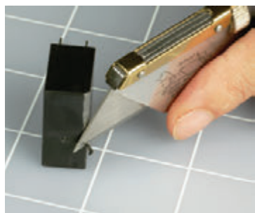
Рис. 2.49. Чтобы посмотреть внутреннее устройство реле, нужно срезать края пластмассового корпуса до тех пор, пока не появится узкий просвет
