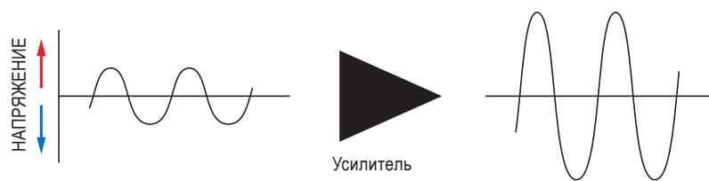
Рис. 5.31. Третий шаг процесса: небольшие по мощности сигналы микрофона проходят через усилитель, который увеличивает их амплитуду, сохраняя частоту и внешний вид волновой формы
