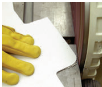
Рис. 5.82. Ленточная пила или дисковый шлифовальный станок идеальные средства для закругления краев при обработке АБС-пластика
