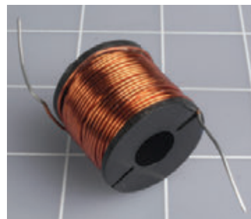
Рис. 5.46. После удаления черной оболочки была обнаружена катушка из обмоточного провода
