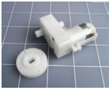
Рис. 5.75. Для этой маленькой роботизированной тележки я нашел двигатель на 5 В, который поставляется с диском, установленным на валу. Этот набор стоит менее $10
