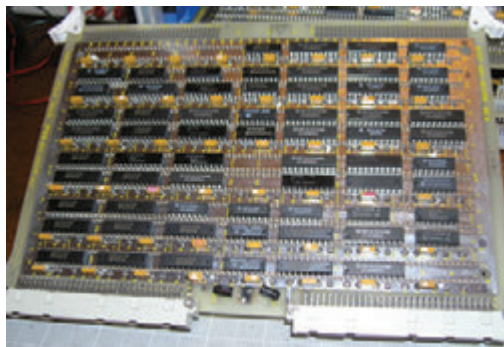
Рис. 4.63. Любитель Билл Базби (Bill Buzbee) самостоятельно собрал веб-сервер полностью на логических микросхемах серии 7400, самая старая из которых была произведена в конце 1969 г. Этот веб-сервер можно найти в Интернете по адресу http://magic-1.org , где приведены фотографии его самого и подробности его конструкции. На рисунке, который представил Билл, показана всего лишь одна плата из его замечательного проекта
