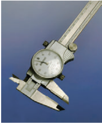
Рис. 3.19. Штангенциркули могут быть цифровыми, которые автоматически преобразовывают миллиметры в доли дюймов от 1/64 до 1/1000, или аналоговыми как тот, который приведен на фотографии. В этом случае вам, разумеется, не придется беспокоиться о замене батарейки
