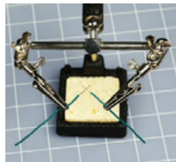
Рис. 3.31. На рисунке показан держатель типа «третья рука», когда в нем зафиксированы два провода с касающимися друг друга оголенными проводками. Увеличительное стекло должно быть убрано в сторону в течение всего процесса выполнения пайки
