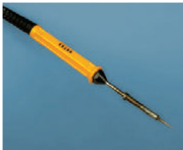
Рис. 3.1. Низкая мощность этого миниатюрного паяльника-карандаша дает возможность применять его без риска повреждения чувствительных компонентов, а тонкое его жало помогает осуществлять выборочный разогрев
