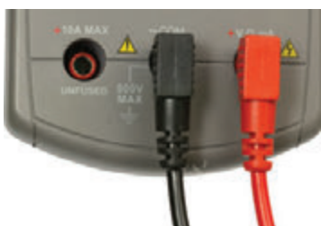
Рис. 1.18. Чтобы измерить сопротивление и напряжение, нужно вставить черный измерительный провод в гнездо «COM», а красный в гнездо «V». Почти все мультиметры имеют отдельное гнездо, в которое вставляют красный измерительный провод только при необходимости выполнить измерение силы тока большой величины в амперах, но мы познакомимся с этой процедурой позднее
