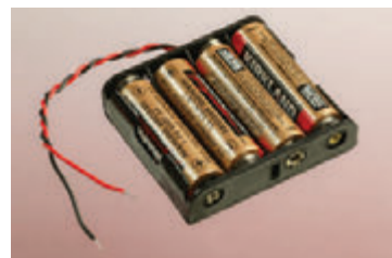
Рис. 1.10. Держатель для четырех батареек типа AA, которые должны быть подключены последовательно, создавая источник с напряжением 6 В
