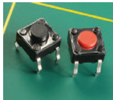
Рис. 4.9. Кнопочный переключатель, который реагирует на нажатие кончиком вашего пальца на кнопку. Это почти всегда однополюсные однопозиционные кнопки типа SPST, сконструированные для установки в платы со стандартным расположением отверстий — с шагом 0,1" (2,54 мм)
