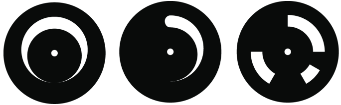
Рис. 5.58. Для создания эффекта тремоло в воображаемом электромеханическом устройстве, которое показано на рис. 5.57, могли бы быть использованы различные рисунки полосок на прозрачном диске
