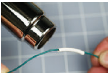
Рис. 3.43. С помощью промышленного фена начните разогрев трубки
