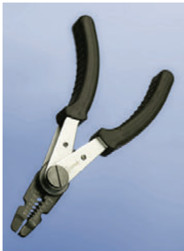
Рис. 2.4. Для того чтобы использовать такой инструмент для снятия изоляции, надо вставить конец изолированного провода в отверстие соответствующего размера между губками инструмента, а затем сжать рукоятки и снять изоляцию
