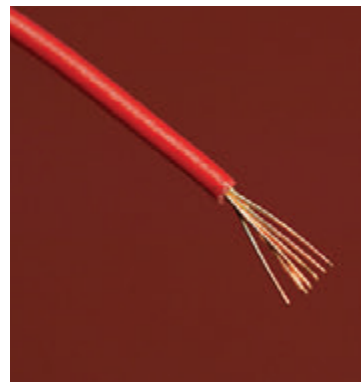
Рис. 2.8. Многожильные провода, состоящие из скрученных проводков, обладают большей гибкостью, но их не всегда легко вставлять в макетные платы
