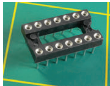
Рис. 4.5. Когда вы припаиваете панельку для микросхем к перфорированной плате, то этим вы устраняете возможный перегрев микросхем при их непосредственном припаивании к плате, уменьшаете риск выхода их из строя за счет воздействия на них статического электричества, а также упрощаете при необходимости замену ИС
