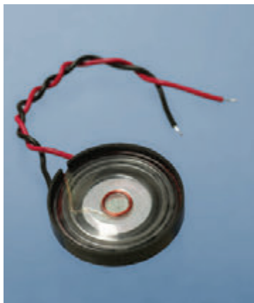
Рис. 2.16. Этот миниатюрный динамик диаметром немногим более 1" (2,54 см) применяется в транзисторных цепях для проверки аудиовыхода
