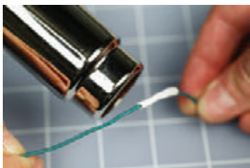
Рис. 3.44. Продолжайте греть трубку до тех пор, пока она плотно не обожмет соединение
