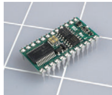
Рис. 5.148. Микроконтроллерный модуль BASIC Stamp состоит из компонентов для поверхностного монтажа, размещенных на печатной плате со штыревыми выводами, которые имеют интервал 0,1" (2,54 мм) и предназначены для установки на макетную плату или перфорированную печатную плату. Этот компонент использует версию языка BASIC, которая аналогична языку программирования для микроконтроллеров PICAXE, но гораздо более обширна. Микроконтроллер BASIC Stamp можно использовать совместно с большим количеством периферийных устройств, включая многочисленные буквенно-цифровые точечные матричные дисплеи
