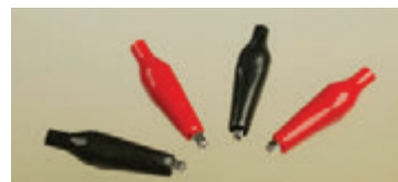
Рис. 1.11. Зажимы типа «крокодил» с виниловой цветной изоляцией, которая уменьшает вероятность случайного возникновения короткого замыкания
