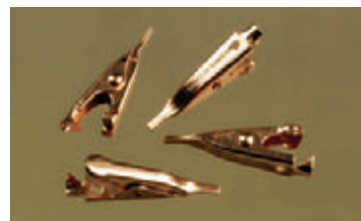
Рис. 3.22. Эти маленькие зажимы отводят тепло, защищая компоненты во время их припаивания
