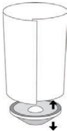
Рис. 2.101. Динамик излучает звук от своей нижней поверхности точно так же, как и от верхней. Чтобы увеличить полезную составляющую аудиосигнала, можно использовать картонную трубку для разделения источников звука или установить динамик в небольшой корпус
