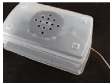
Рис. 5.40. Просверлите несколько отверстий диаметром 1/2" (12 мм) в нижней части коробки, затем закрепите динамик на месте болтами, протянув провод через одно из отверстий в боковой части. Установите крышку и вы будете готовы для прослушивания звука, разумеется, не слишком высокого качества.
